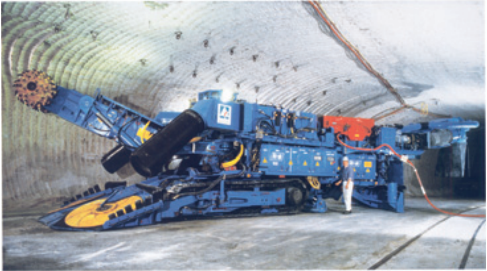
Schneidende Gewinnungsmaschine WAV 400-S mit einer Antriebsleistung von 400 kW am Schneidkopf
