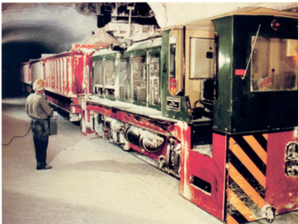
Lokomotivförderung auf der 940 m-Sohle. Es sind zur Zeit zwei Loks mit je 12 Wagen im Einsatz
