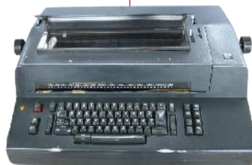
Der IBM Composer: Mit dieser elektrischen Schreibmaschine mit Randausgleich und auswechselbaren Schrifttypen wurde das erste Who is Who in Österreich produziert. The IBM Composer: this typesetting machine — with full justification and exchangeable fonts — was used to produce the first Who is Who in Österreich.
